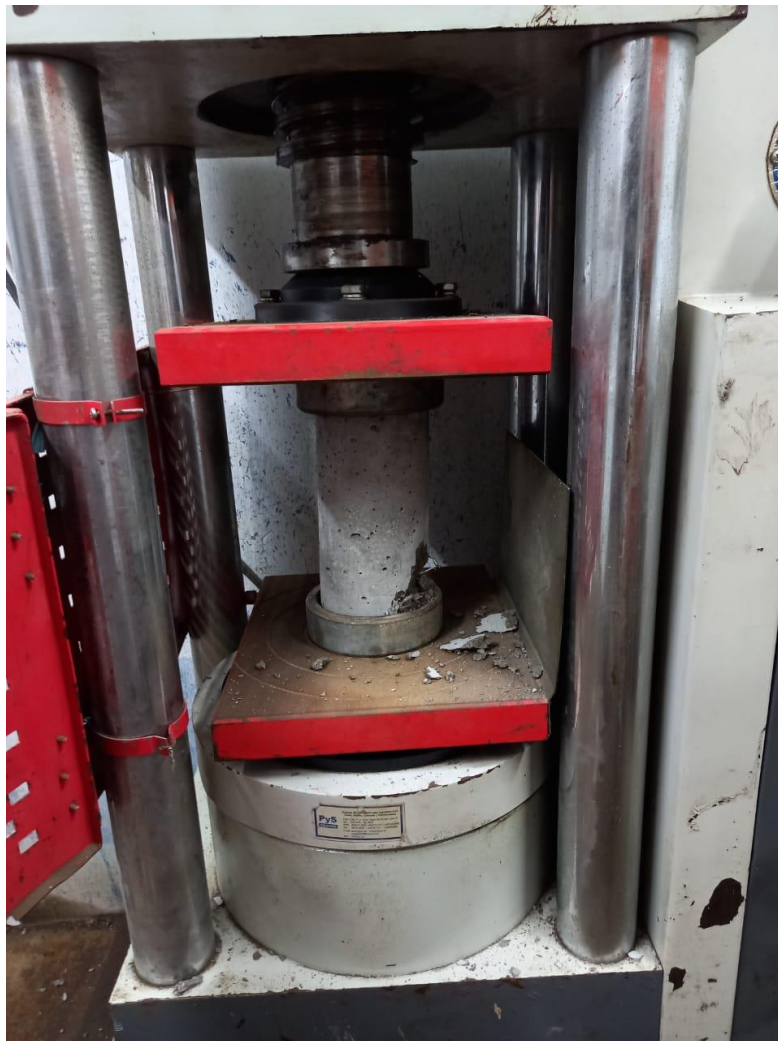
Figura 01: Prensa de compresión y probeta de concreto, midiendo su máxima resistencia.
