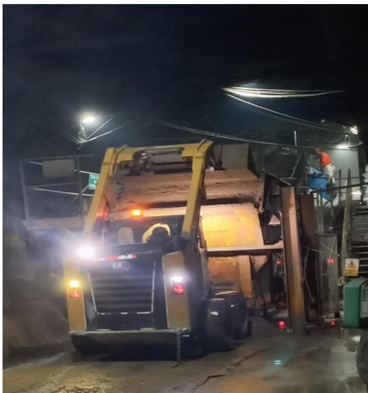
Figura. 01: Abasteciendo de arena a la tolva con minicargador
