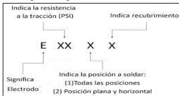
Fig. 1 Designación de Electrodo
