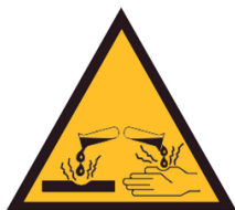
Riesgo de contacto con ácido corrosivo
