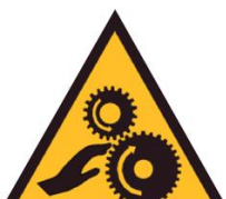
Riesgo de atrapamiento
