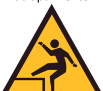
Riesgo de caída a distinto nivel
